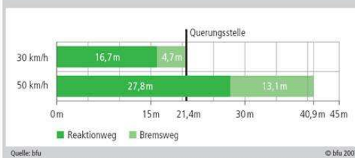
Anhalteweg bei 30 km/h und 50 km/h bei trockener Fahrbahn
